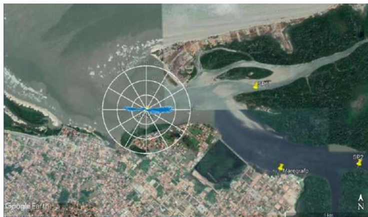
Figura 3: Localização do ADV1 e registro da intensidade e direção da corrente.
